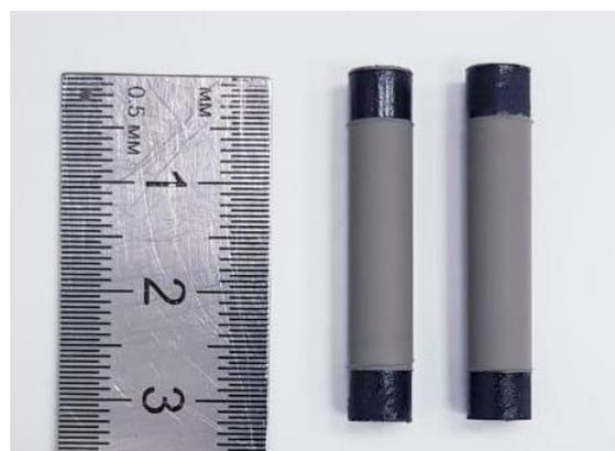
**Электрохимическая ячейка с кислородпроводящим твердым электролитом – базовый элемент для генератора гипероксических смесей.**
